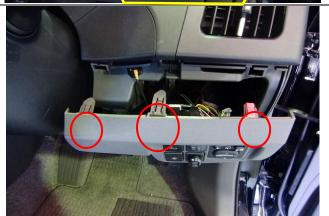
2 パネルを外したら、ドアミラースイッチに繋がっているコネクタを外します。コネクタはツメを押しながら引っ張ると抜けます。
